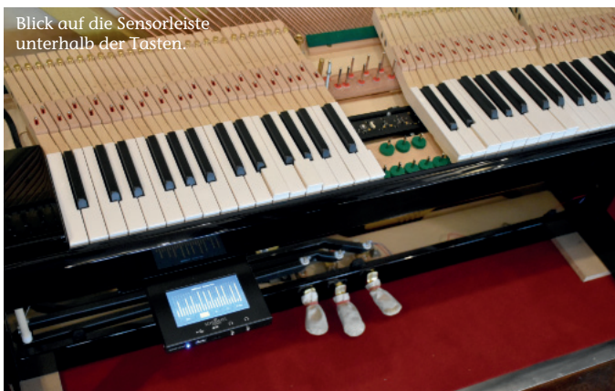
Unterhalb der Hammerköpfe erkennt man die neue Stopperleiste.
